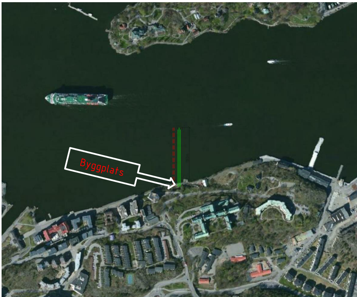
Figur 1. Henriksdalsverkets vattenutsläpp. Befintliga utloppsrör i heldragna gröna linjer. Streckad linje visar de två planerade nya utloppsrören.
