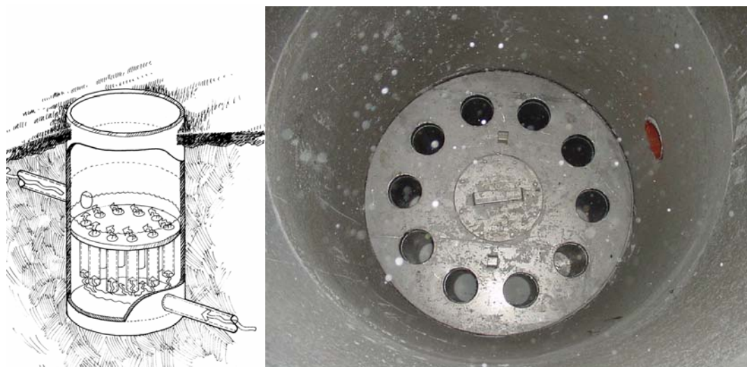
Figur 3.3. Biofiltrets inlopp finns i filtrets nedre del och utloppet i överdelen. Vattnet pressas uppåt genom filtret, vars mikroorganismer lever på de nedbrytbara föroreningarna.
